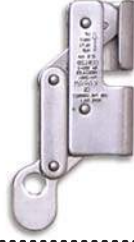
KK 02 Çelik Halat Tutucu 15 kN Min. Kop. Gücü 8 mm Ağırlık: 473 gr.
