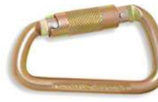
KK 113 Karabina Otomatik 25 kN Min. Kopma Gücü, 236 gr. A. Açıklığı 23 mm EN 362:2004 Sınıf B
