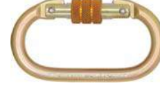
KK 112 Karabina 25 kN Vidalı Ağız Açıklığı 17mm 160.5 gr. EN 362:2004 Class B - Class M
