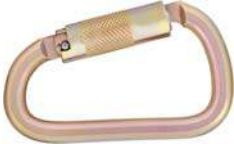
KK 113 BE Karabina Otomatik 25 kN Min. Kopma Gücü, 250 gr. A. Açıklığı 22.5 mm EN 362:2004 Sınıf B
