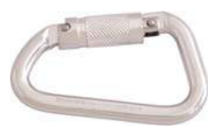
KK 118 Karabina Otomatik 20 kN Min. Kopma Gücü, 79 gr. A. Açıklığı 22 mm EN 362:2004 Class B
