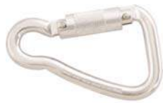
KK 127 Al. Karabina Otomatik 20 kN Min. Kopma Gücü, 87.4 gr. A. Açıklığı 22.5 mm EN 362:2004 Class B
