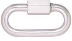
KK 103 Çelik Vida Bağlantı 25 kN Vidalı 80 gr. Ağız Açıklığı 11mm
