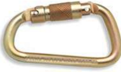
KK 114 Karabina 3'lü Kilitlemeli 25 kN Min. Kopma Gücü, 233.4 gr. A. Açıklığı 23 mm EN 362:2004 Class B
