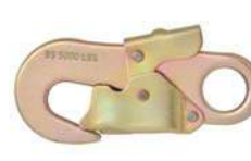
KK 121 Çelik Kanca 25 kN Min. Kopma Gücü, 205.3 gr. A. Açıklığı 17 mm EN 362:2004 Class T
