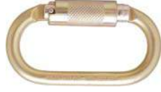
KK 111 Karabina Otomatik 25 kN Minimum Kopma Gücü Ağız Açıklığı 16mm EN 362:2004 Class B
