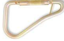
KK 134 Kule Kanca 25 kN Min. Kopma Gücü, 725 gr. A. Açıklığı 50 mm EN 362:2004 Sınıf T
