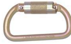
KK 115 Karabina Otomatik 25 kN Min. Kopma Gücü, 210 gr. A. Açıklığı 23 mm EN 362:2004 Class B
