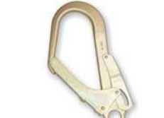
KK 131 Büyük Kanca 23 kN Min. Kopma Gücü, 473 gr. A. Açıklığı 55 mm EN 362:2004 Class T
