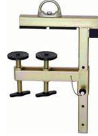
KA 11 | Beton Çapası Yüksek Mukavemetli Çelik Galvaniz Kaplı Ağırlık 8.575 Kg. EN 795:1996 Sınıf B
